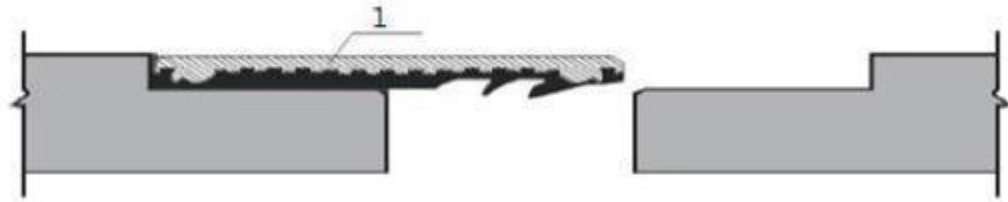
图5.10.4-2 有内水压双插口接头
