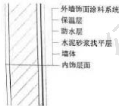
图 5.6.4 外墙整体防水构造
