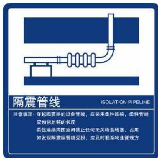
图 H.0.7-5 隔震管线标识
