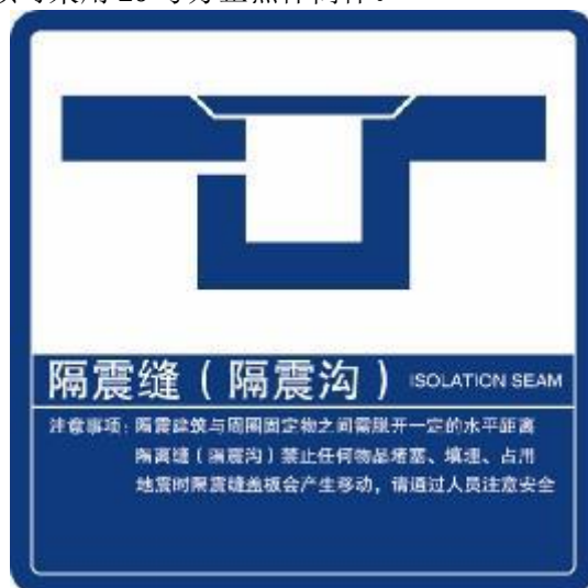
图 H.0.7-3 隔离缝 (隔震沟) 标识
