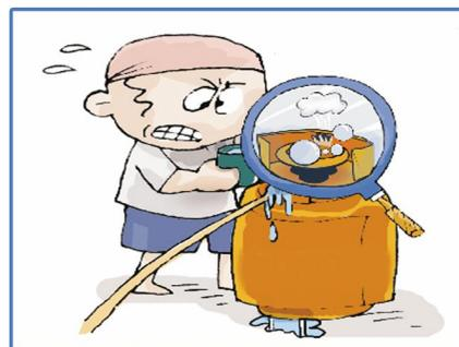
平时用肥皂水查漏，冒泡即漏气
